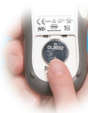
1. Откройте крышку отсека для батарейки на задней панели прибора, нажав на выступ фиксатора в направлении стрелки и приподняв крышку. Извлеките старую батарейку.
