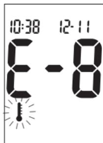
Temperatura je iznad ili ispod dopuštenog raspona za aparat ( $6^{\circ}\text{C}$  do  $44^{\circ}\text{C}$ ). Pomaknite se u područje s temperaturama od  $6^{\circ}\text{C}$  do  $44^{\circ}\text{C}$ , pričekajte pet minuta i ponovite mjerjenje. Nemojte zagrijavati ni hladiti aparat na umjetan način.
