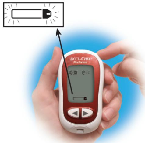
5. Za postavljanje više mogućnosti kratko pritisnite . Za izlaz pritisnite i držite dok se ne pojavi simbol titrajuće test trake.
