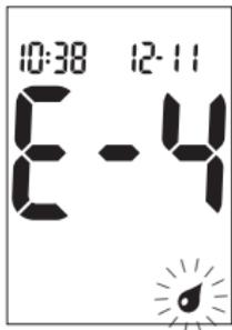
На тест-полоску нанесено недостаточное количество крови или контрольного раствора для выполнения измерения или же кровь или контрольный раствор были нанесены уже после начала измерения.
