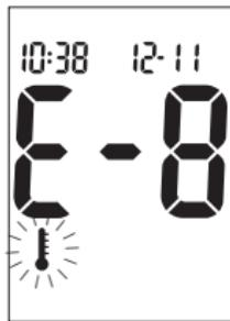
Температура выходит за диапазон рабочих температур прибора (от 6°C до 44°C). Перенесите прибор в помещение с температурой от 6°C до 44°C, подождите пять минут и повторите измерение. Не подвергайте прибор принудительному нагреву или охлаждению.
