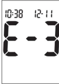
Pojavila se greška tijekom mjerjenja. Bacite test traku i ponovite mjerjenje.
