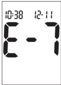
Произошла ошибка электронной системы или, в редких случаях, была извлечена и снова вставлена уже использованная тест-полоска. Выключите и снова включите прибор или извлеките на несколько секунд батарейку, а затем снова вставьте ее.
