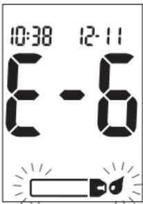
Krv ili kontrolna otopina nanesena je na test traku prije nego što je na zaslonu počeo titrati simbol kapi. Bacite test traku i ponovite mjerjenje.
