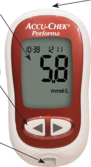
Инфракрасный (ИК) порт - для передачи данных из прибора в ПК или «наладонник».
