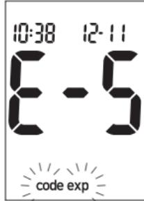
Čip za kodiranje dolazi iz serije test traka kojoj je istekao rok valjanosti. Provjerite podudara li se kôd na zaslonu s kodom otisnutim na kutiji test traka. Provjerite i točnost vremena i datuma u aparatu.
