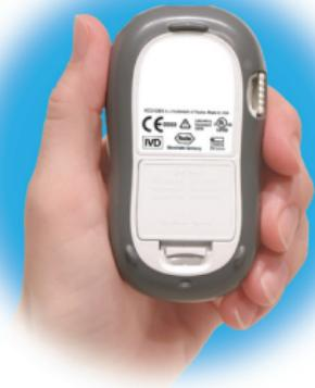
4. Переверните кодовую пластинку стороной с номером кода от себя. Вставьте кодовую пластинку в гнездо прибора до упора.
