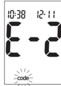
Neispravan čip za kodiranje. Isključite aparat i umetnute novi čip za kodiranje. Ako problem i dalje postoji, nazovite Roche Diagnostics.
