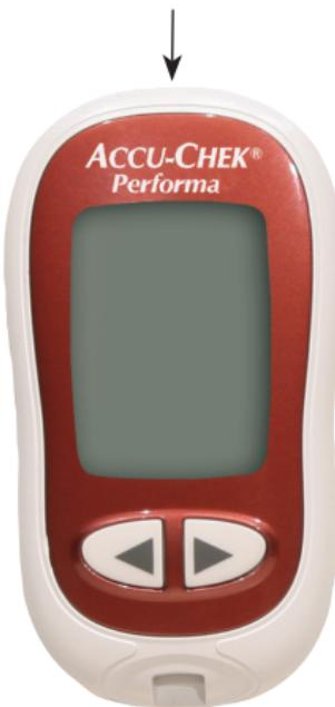
**6.** Smjestite aparat na ravnu površinu i poravnajte infracrvene prozorčice na aparatu i kabelu ili PDA (udaljenost mora biti između 3 do 10 cm).
