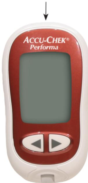
**6.** Stavite merač na ravnu površinu, a zatim stavite infracrvene portove na meraču i kabl ili PDA jedan naspram drugog (trebalo bi da budu međusobno udaljeni od 3 do 10 cm)
