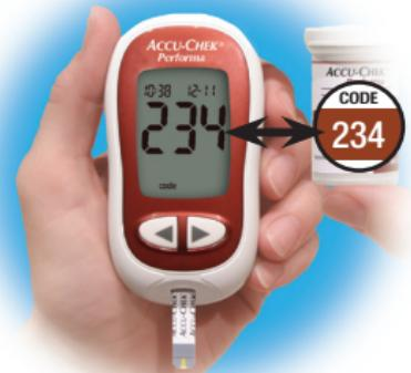
4. Убедитесь в том, что номер кода на дисплее соответствует номеру кода на тубусе с тест-полосками. Если Вы пропустили момент отображения кода на дисплее, извлеките тест-полоску и еще раз вставьте ее в прибор.
