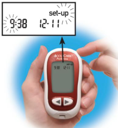
1. Включите прибор, нажав и отпустив . На дисплее отобразятся время и дата. Мигают "set-up" и цифра часа.
